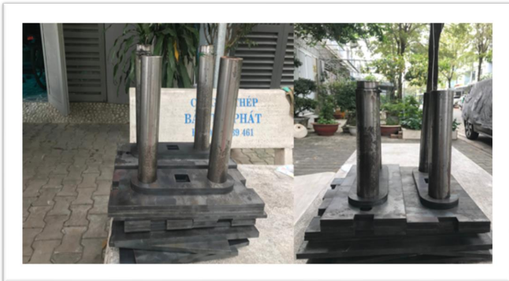
Hình 3. Các chi tiết khuôn gạch lego được gia công bằng CNC
